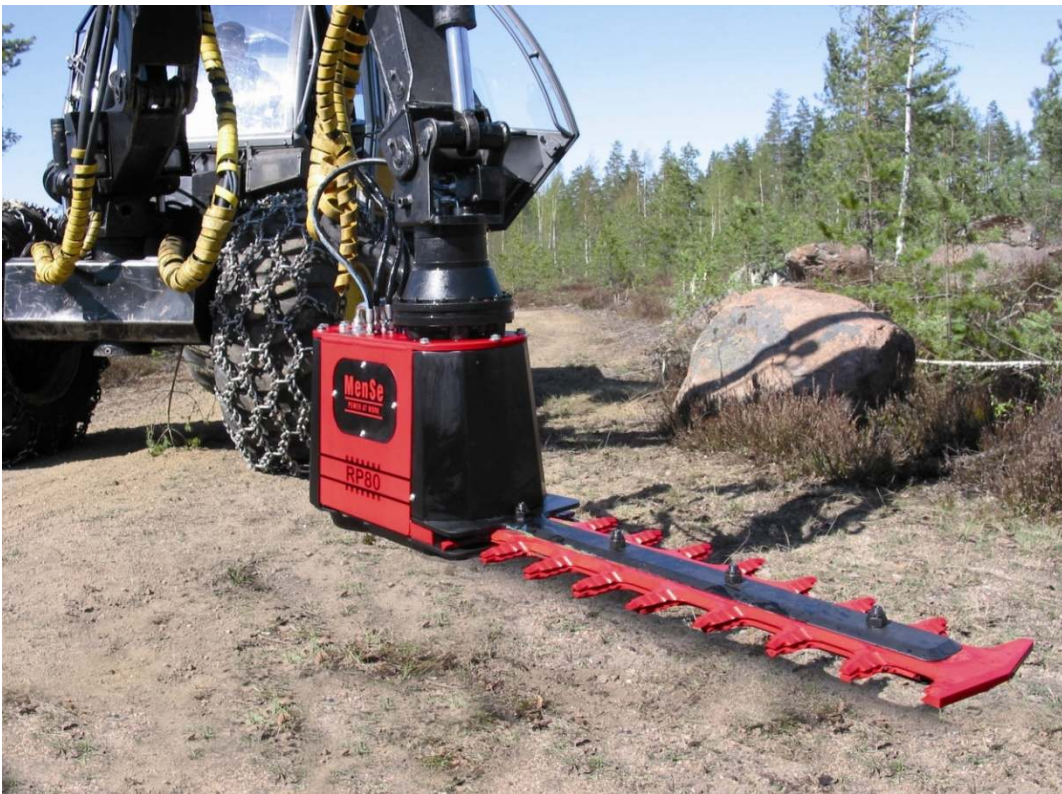
Kuva 4. MenSe -raivauslaite kevyeen hakkuukoneeseen asennettuna. Kuva: MenSe Oy.
