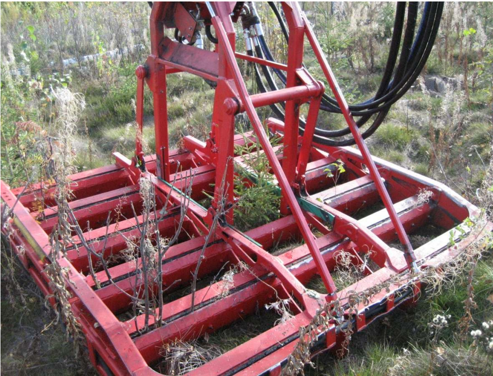
Kuva 6. Kitkevä laite työssä. Kasvatettava taimi laitteen keskellä. Poistettavat vesat puristetaan leukojen väliin ja nostetaan maasta juurineen. Kuva: Arto Mutikainen.
